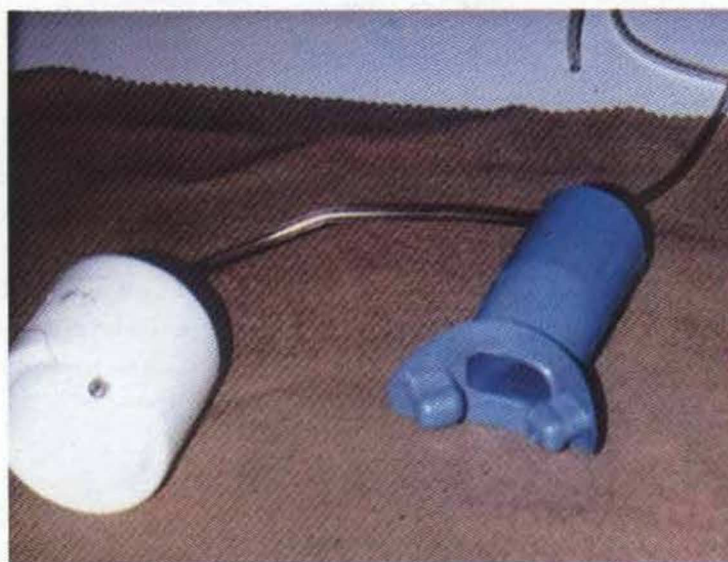
Fig. 1 – Peça tubular de plástico rígido de diâmetro interno largo e peça bucal usual de tipo mergulhador
