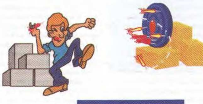
Fig. 1 – Conceito de Precisão – Imprecisão. As setas a rosa representam resultados precisos (mas não exactos !), ao contrário do conjunto das setas amarelas.
