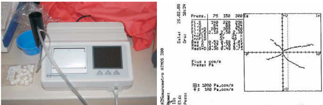
Fig. 1 – Rinomanómetro e representação gráfica de um exame
